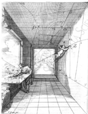
Figuur 2: uitzetten van een zonnewijzer met een horizontaal spiegeltje als lichtend punt
