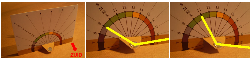
Figuur 6: homogene zonnewijzer op een zuidvlak
