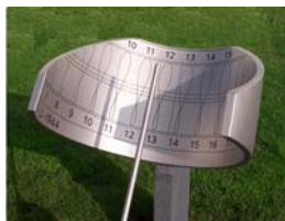
Figuur 1: de schaduw van de top van de poolstijl geeft de tijd aan
